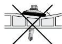
Rysunek 13c Nieprawidłowe - nieprostopadle wiercenie i wstawianie
