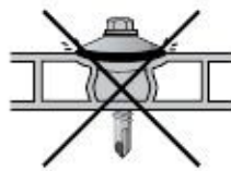
Rysunek 13a Niepoprawnie - Nadmierne dokręcenie
