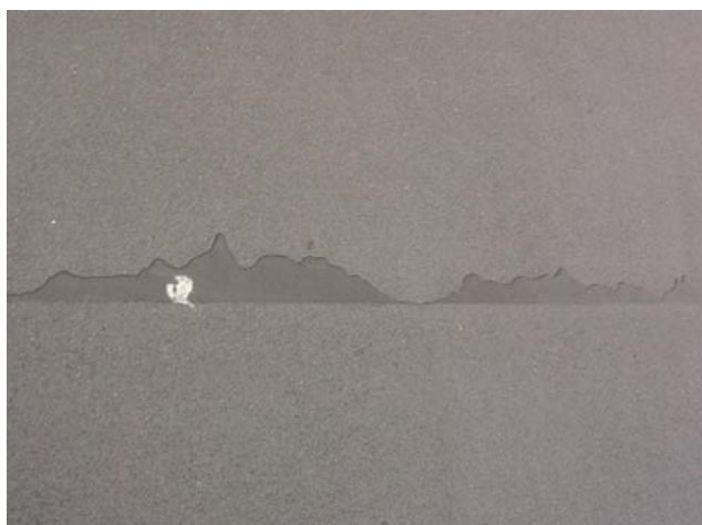
Fot. 27 Przegrzanie materiału podczas zgrzewania
